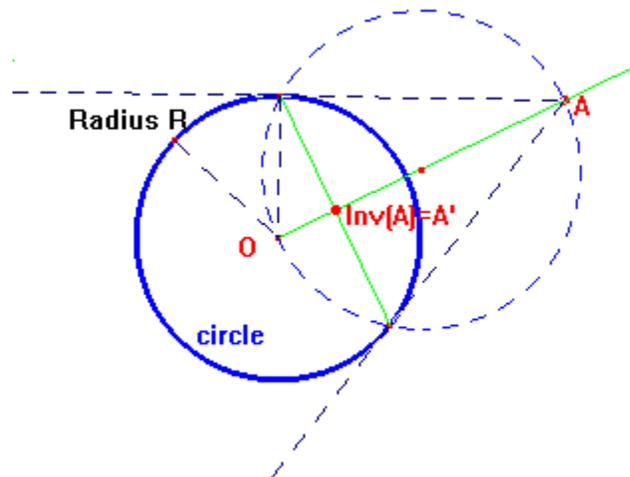
Figura 10: Construção geométrica da Inversão de um ponto relativa a um círculo.
