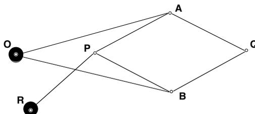
Ela consiste de dois pontos fixos  $O$  e  $R$  e pontos móveis  $A, B, P$  e  $Q$ , bem como de hastes rígidas de comprimentos  $OA = OB$  e  $AP = AQ = BP = BQ$ .
